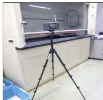
有機溶剤の作業環境測定状況
