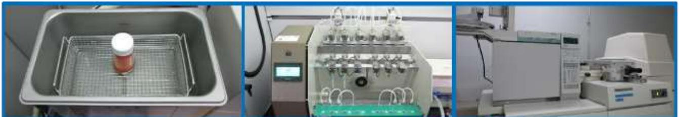
PCB含有量試験 (抽出～クリーンアップ～HRGC/HRMS測定)
